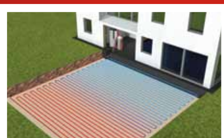
Земен източник - повърхностен колектор на директно изпарение
